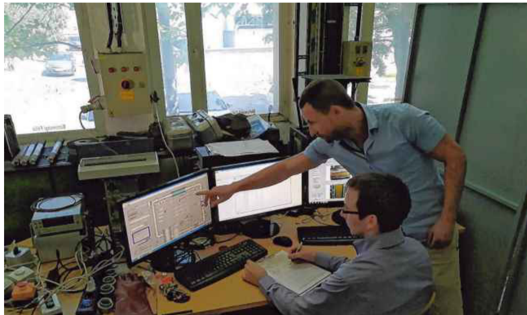
Az Ecotech két munkatársa, Kocsó Endre és Molnár János a cég által tervezett és épített bevonatvizsgáló berendezés szabályozó és monitorozó egységén figyeli az eredményeket
